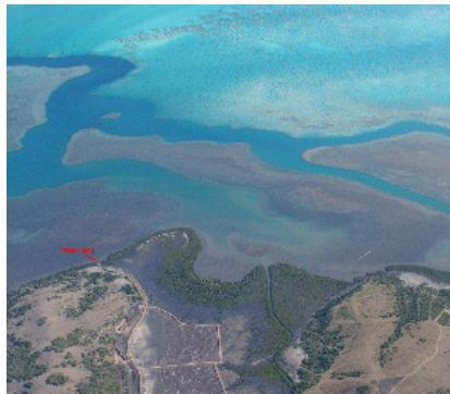
Photo 46 – Site de pompage (en rouge) handicapé par la faible profondeur du platier.
