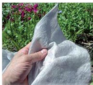
Photo 35 - Géotextile employé pour assurer l'étanchéité des moines d'entrée et de sortie
