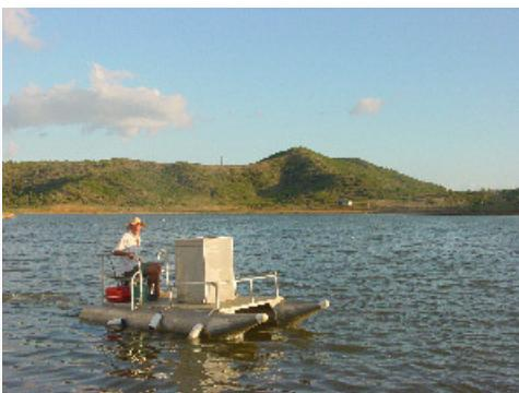
Photo 42 – Catamaran aluminium et son silo amovible sur une ferme familiale. Intérêts : facilités à charger, à maintenir propre, confort. Inconvénients : prix, manœuvrabilité pour remonter les mangeoires, une unité/bassin.
