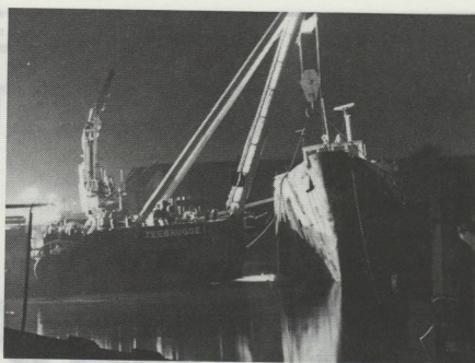
Het bergingsvaartuig Zeebrugge I hield het schip maandagnacht in de stroppen tijdens het leegpompen van het voorschip. (gw)
