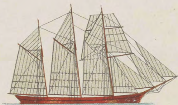
SCHOENERTUIG. SCHONERTAKELUNG. SCHOONER RIG. GRÉEMENT EN GOËLETTE.
