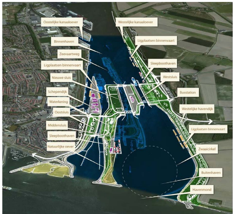
Figuur 5-1: Verklaring gebruikte begrippen (de ondergrond is gebaseerd op de tekening van de voorkeursvariant)
