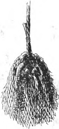
Fig. 81. — Radasse montée sur une corde.
