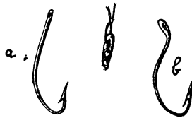
Fig. 19. — Hameçon à chas. a, Forme Limerick ; b, forme américaine.
