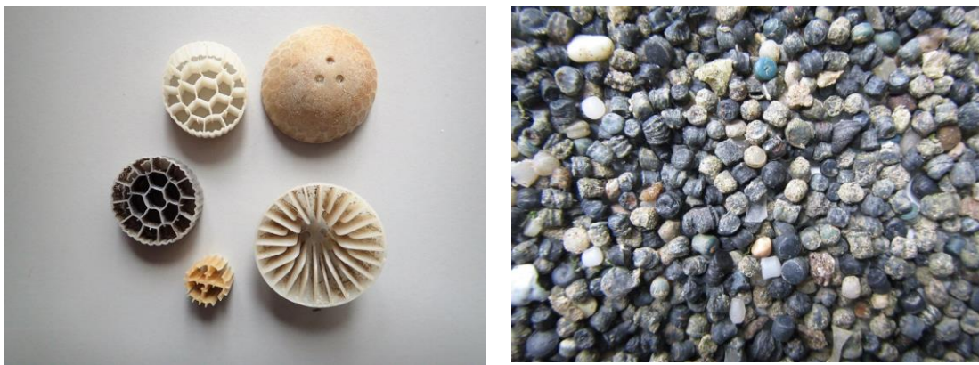
Figuur 6. Biomedica: Camenberts en Picobells (links) en Biobeds (rechts) gebruikt voor de zuivering van afvalwater in filterinstallaties (Copyright: Francis Kerckhof; Francis Kerckhof, 2019 ).
