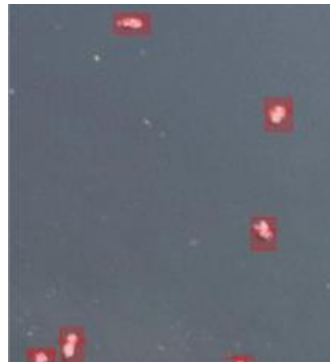
Figuur 3. Lokale testvlucht met een drone met een RGB-camera boven plastic flessen die in het meer bij Mol drijven. Rechts is een resulterend dronebeeld te zien waarin de plastic flessen zijn gedetecteerd met het AI-model (VITO).
