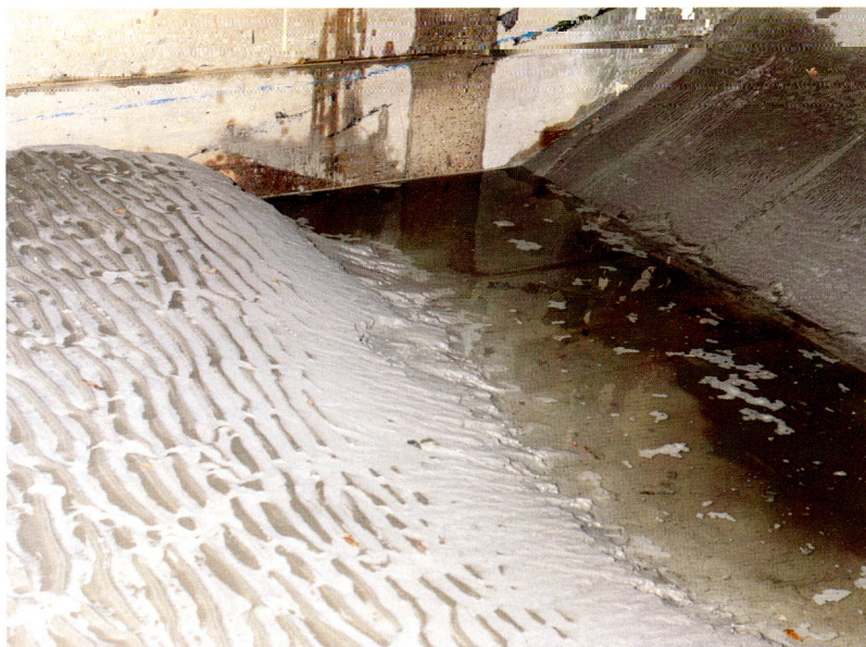
Fig. 6.4 Ontgrondingskuil voor een duinvoetverdediging na het optreden van een stormvloed (modelonderzoek Waterloopkundig Laboratorium).
