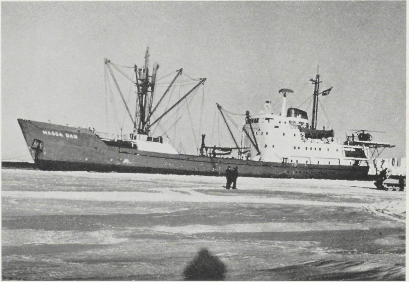
Fig. 4. Le « Magga Dan » vient d'accoster la glace de mer dans la baie Léopold III. L'épaisseur de la glace, de près de 2 mètres permet le débarquement du matériel qui sera acheminé vers la base Roi Baudouin.
