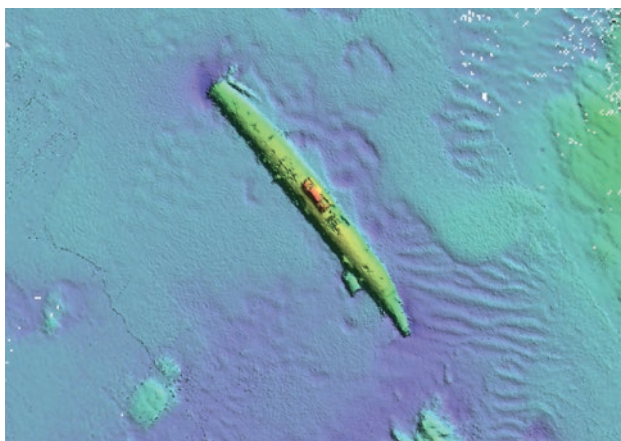
Abb. 6: Multibeam-Aufnahme des Wracks des deutschen Unterseeboots UC-42, das im Verlauf des Meeresboden-Kartierungsprogramms von INFOMAR in küstennahen Gewässern vor der Südwestküste Irlands entdeckt wurde. © INFOMAR
