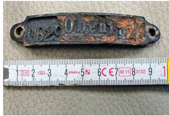
Abb. 7: Das kleine Bronzeschild, das die Identifizierung des UB-29 ermöglichte. © Termote
