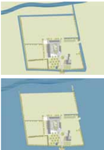
Figuur 102 Hoeves in noodberging blijven beschermd door een aarden wal omheen het ensemble (eigen verwerking van ontwerp kloosterboerderij door E'SCAPE & Green-YD)
