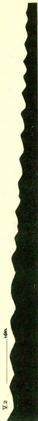
Fig. 22. Profiel door het ribbeld van proef V.
