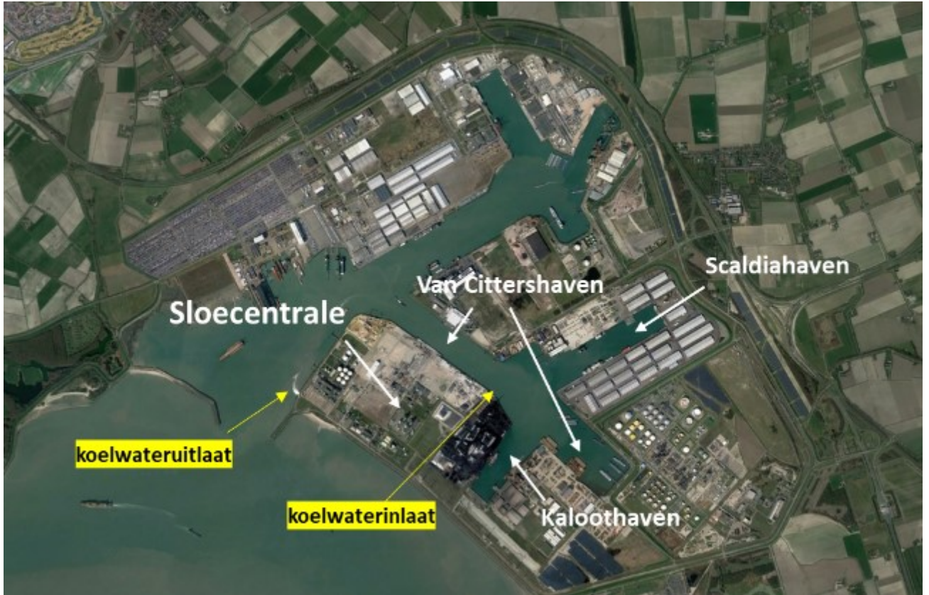
Figuur 1 Ligging van de Sloecentrale, aangrenzende havens en de locaties van de koelwater in- en uitlaat.
