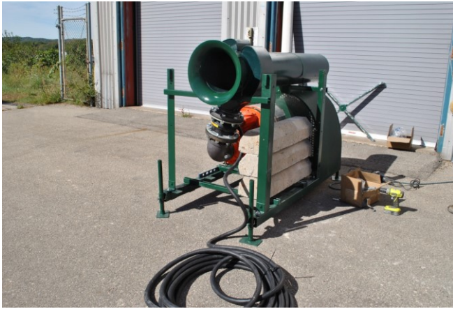
Figuur 12 Voorbeeld van een Flow Velocity Enhancement System (FVES), een pomp die gebruikt wordt om een waterstroom te genereren om objecten weg te leiden van inlaatlocaties. Uit: EPRI (2013)
