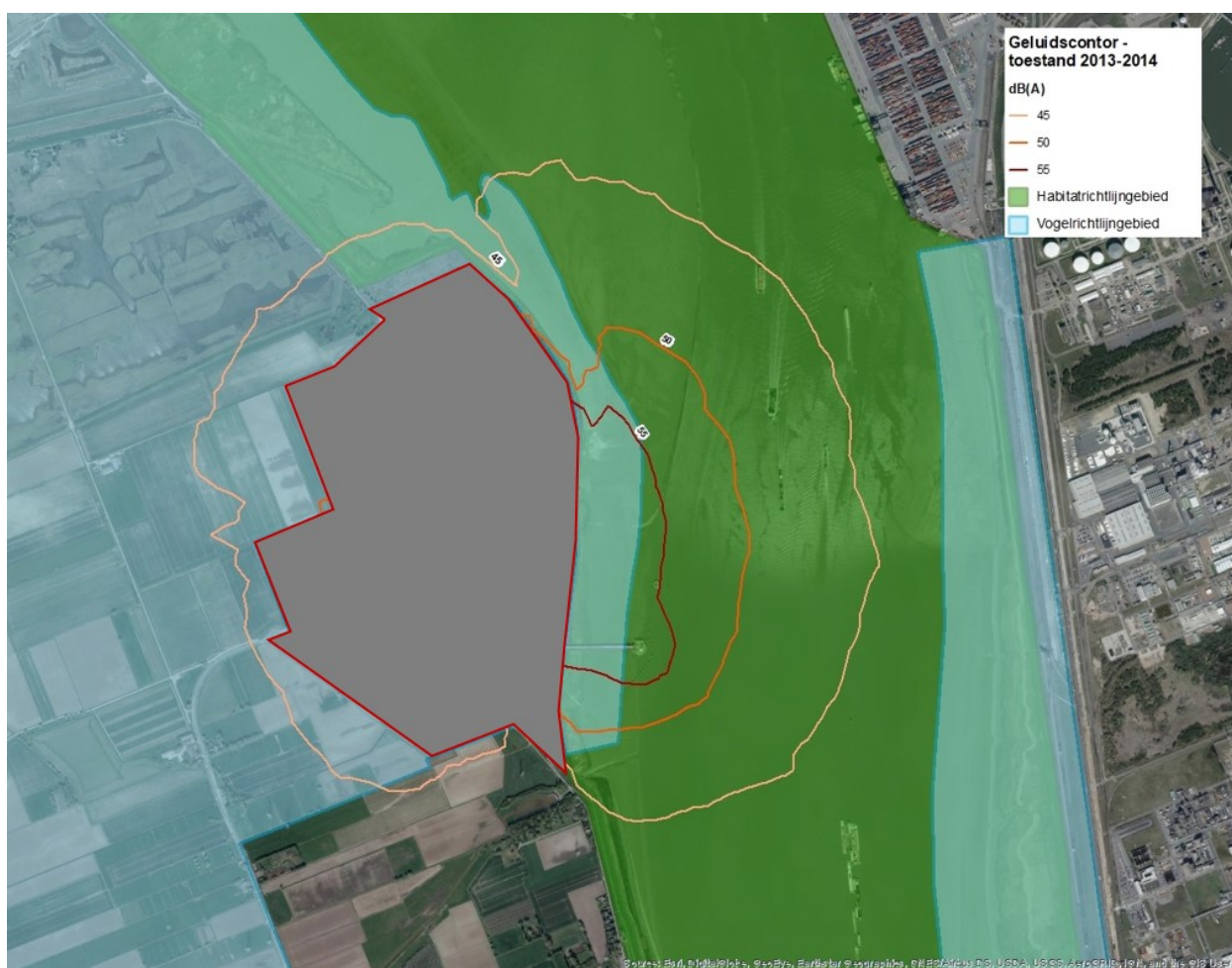
Figuur 2-59 Geluidscontouren 2013-2014 (ook dezelfde voor de bedrijfsfase 2015-2018) ten opzichte van Natura 2000-gebieden
