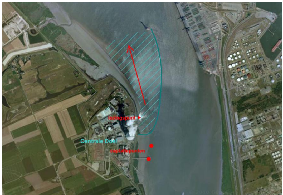
Figuur 2: Zone met waarneembare temperatuursverhoging bij afgaand water, strekdam boven water
