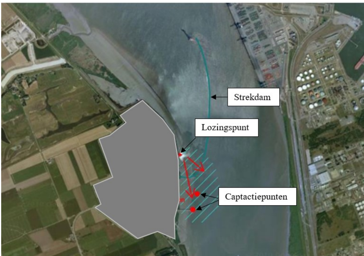
Figuur 2-33 Maximale zone met waarneembare temperatuursverhoging (>1°C) bij opkomend water
