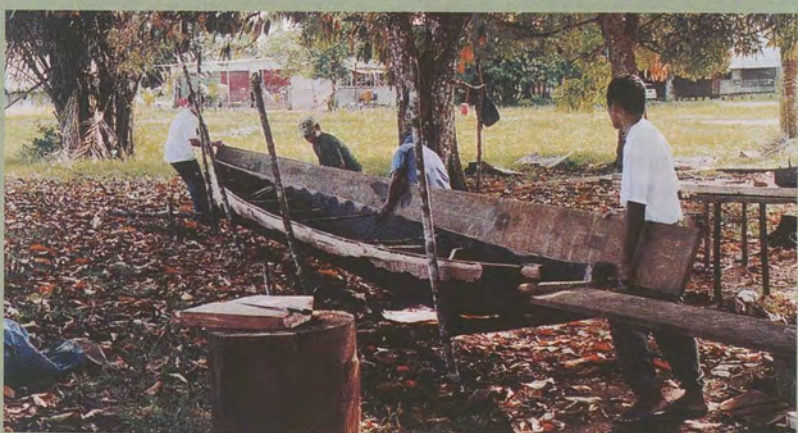
Fixation des bordages : les côtés rehaussés d'une cinquantaine de centimètres, la coque est bientôt prête à affronter les flots.
