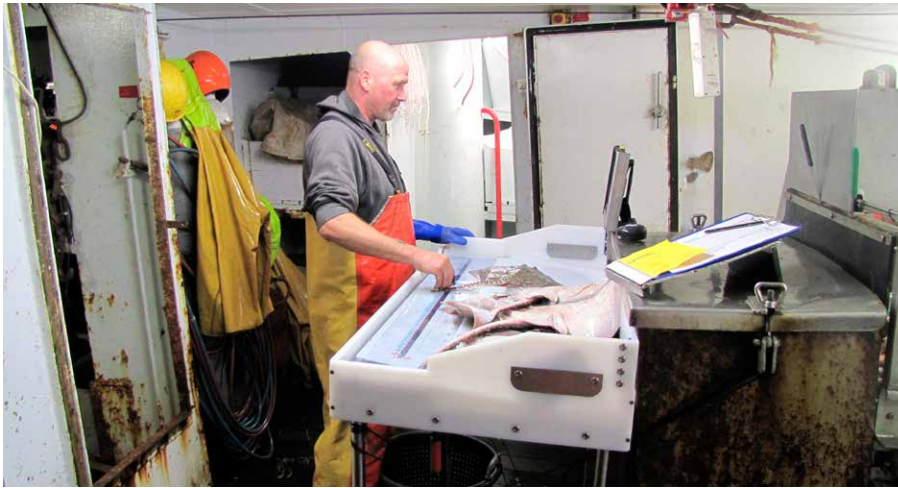
Een zeegaande waarnemer van het ILVO gebruikt een digitale meetplank om accuraat de lengte van een vis te meten. De waarnemer stuurt de gegevens direct door naar een laptop die alle data automatisch opslaat. Bij terugkomst van een zeereis downloadt de waarnemer de gegevens rechtstreeks in de ILVO-databank. Vóór gebruik ondergaan deze data nog een aantal kwaliteitscontroles (ILVO).
