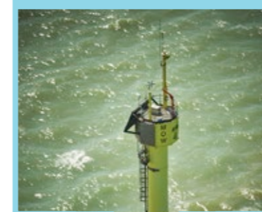
De palen van het Meetnet Vlaamse Banken verzamelen o.a. weergegevens, en meten zeewatertemperatuur en getijhoogte. ©MDK Cofely Fabricom
