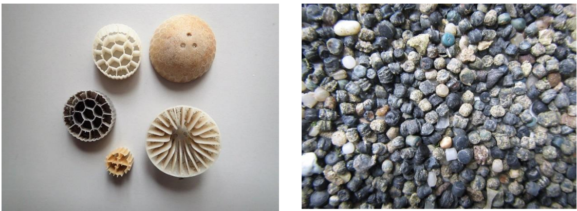
Figuur 7. Biomedia: Camemberts en Picobells (links) en Biobeds (rechts) gebruikt voor de zuivering van afvalwater in filterinstallaties (Copyright: Francis Kerckhof; Francis Kerckhof, 2019 ).
