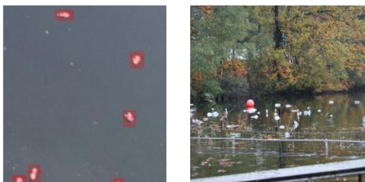
Figuur 4. Lokale testvlucht met een drone met een RGB-camera boven plastic flessen die in het meer bij Mol drijven. Rechts is een resulterend dronebeeld te zien waarin de plastic flessen zijn gedetecteerd met het AI-model (VITO).
