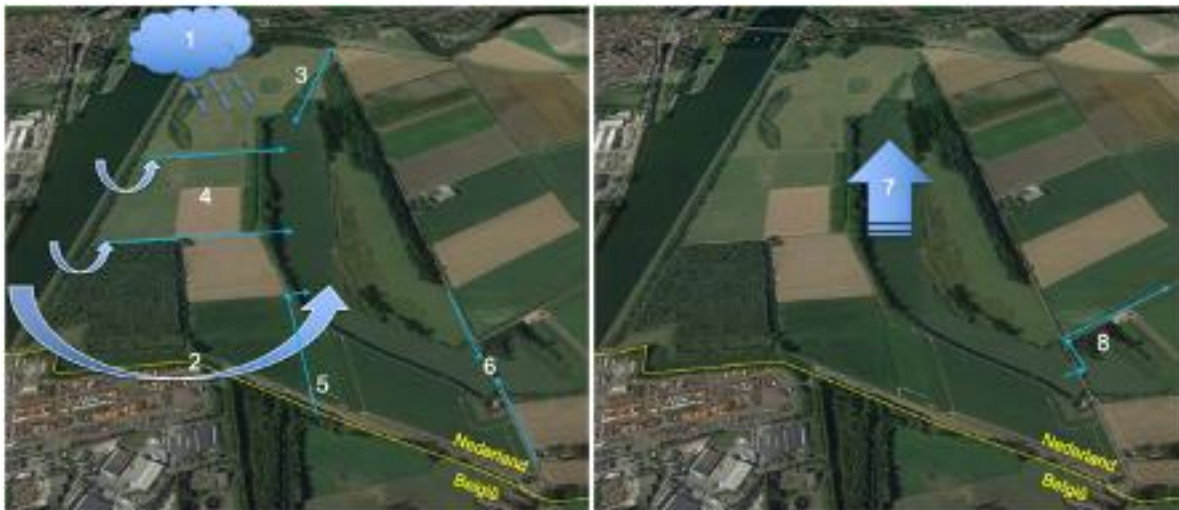
Figuur 5: Geïdentificeerde posten van de waterbalans met aanvoer links en afvoer rechts: 1. neerslag, 2. grondwaterkwel, 3. sloot noordzijde*, 4. kwel sloten west, 5. sloot Zelzate, 6. wegsloten, 7. verdamping en 8. Afvoer stuw Vissersverkorting. *: sloot noordzijde bleek geen aanvoer-, maar incidentele afvoersloot.
