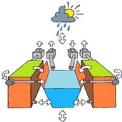
Figuur 6: Schematische weergave van de gebruikte waterbalans. In het midden het waterbakje, daarnaast twee bakjes bodem.
