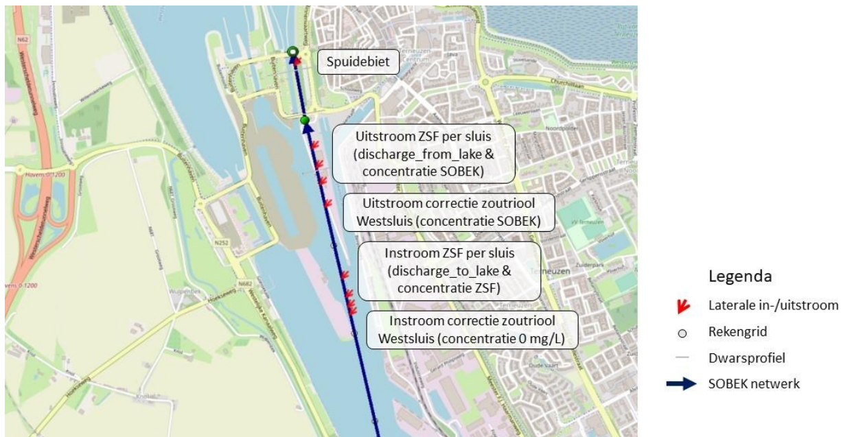
Figuur 4-10: De locaties voor de in- en uitvoer van de uitkomsten van de ZSF in het SOBEK-model.
