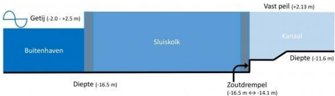
Figuur 2-7: Schematische weergave van Nieuwe Sluis en zoutdrempel (bron: nieuwesluisterneuzen.eu )
