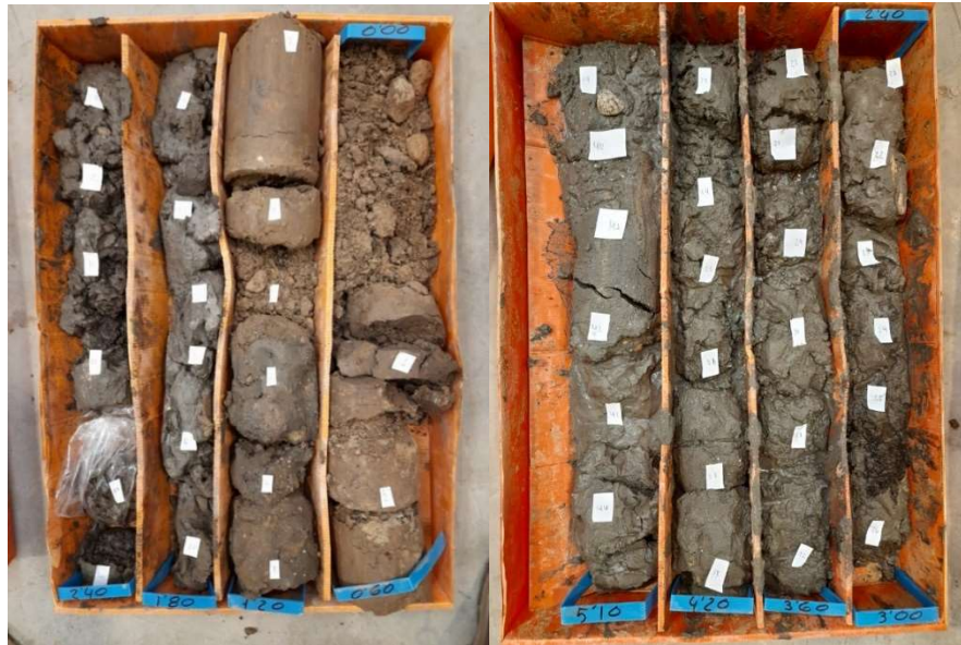
Figura 12 - Separación y clasificación del testigo. Fuente: elaboración propia
