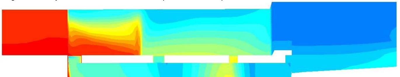
Figuur 6.5.d: zijaanzicht nieuwe sluis zonder spuien; zeedeur open
