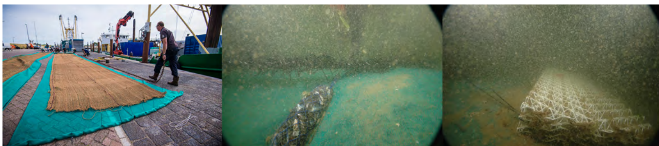
Afb. 2 Overzicht van de verschillende controle-elementen voor de aangroei van hard substraat. Links ligt het kokostouw op het steigergaas. In het midden zijn netten te zien gevuld met lege mosselschelpen, geplaatst op het steigergaas. Op de achtergrond is het Christmas rope te zien. Rechts ligt het kratje van zetmeel.
