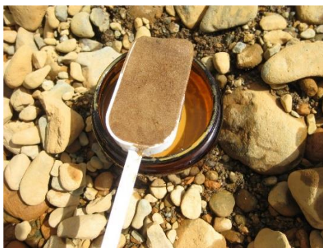
Fig. 7 – Pá para recolha de sedimentos (U.S. Geological Survey)
