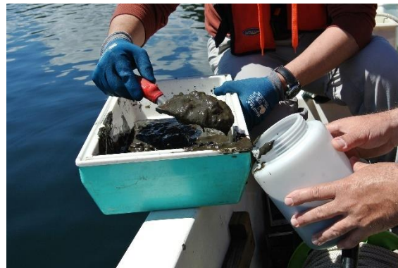
Fig. 35 – Colheita da amostra 1.1 de sedimentos de fundo (maio de 2016)
