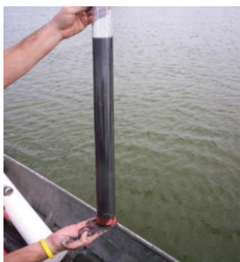
Fig. 8 – Núcleo recolhido com um Ogeechee corer na albufeira de Rasmussen (EUA) (Straub et al. , 2006)
