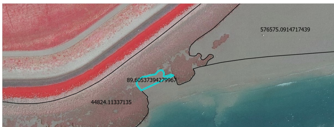
Figuur 11: Voorbeeld elimineeractie vlakje <100m 2 uit de e-GMK. Het vlakje P1a2 is door het afsnijden op de 4% DVD-lijn kleiner geworden dan volgens de specs is toegestaan. Dit vlakje is bij het hardsubstraat vlak toegevoegd.
