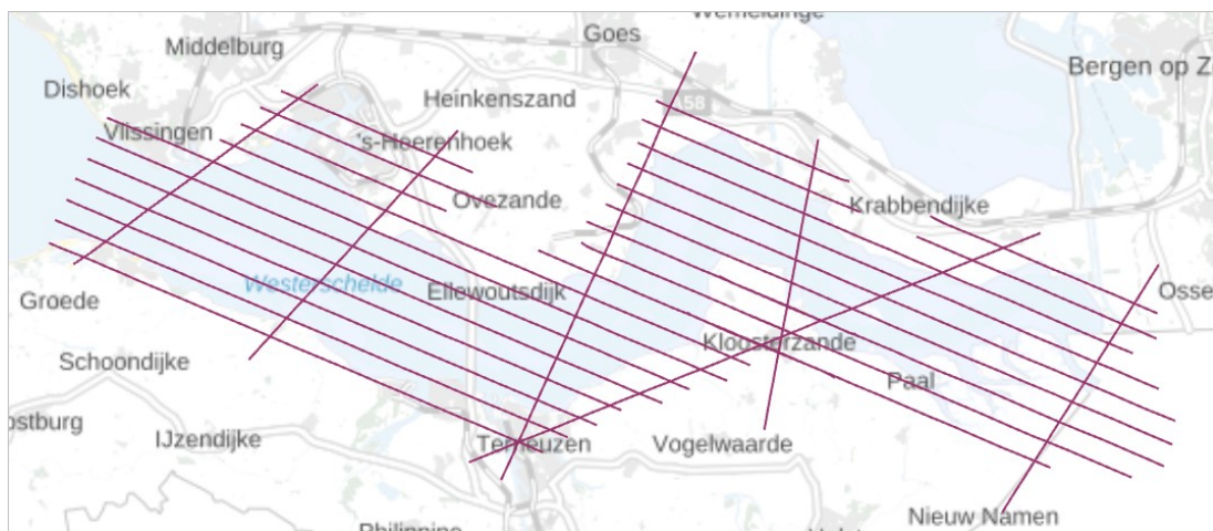
Figuur 4: vlieglijnen laseraltimetrievlucht 2022
