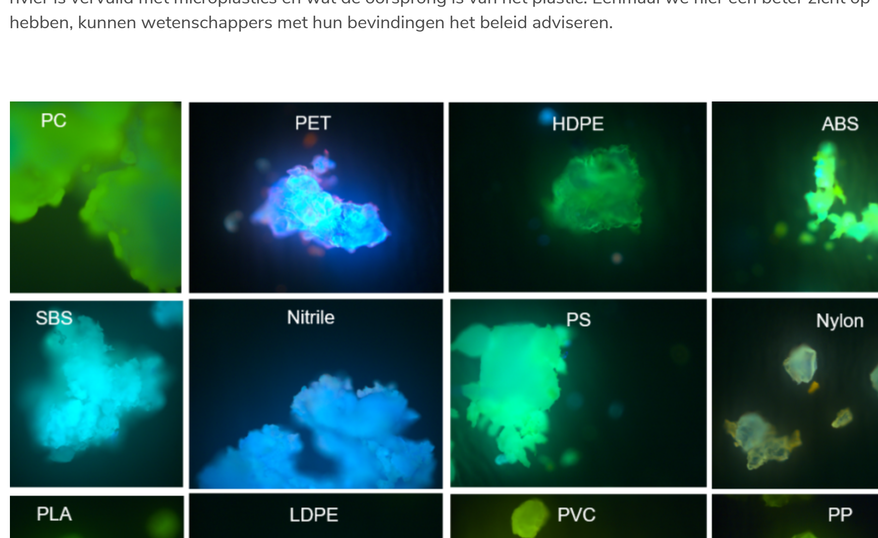
Een overzicht van verschillende microplasticpolymeren, gefotografeerd met een fluorescentiemicroscoop onder UV-licht. Elke microplasticpolymeren licht anders op en heeft een eigen RGB-waarde.
