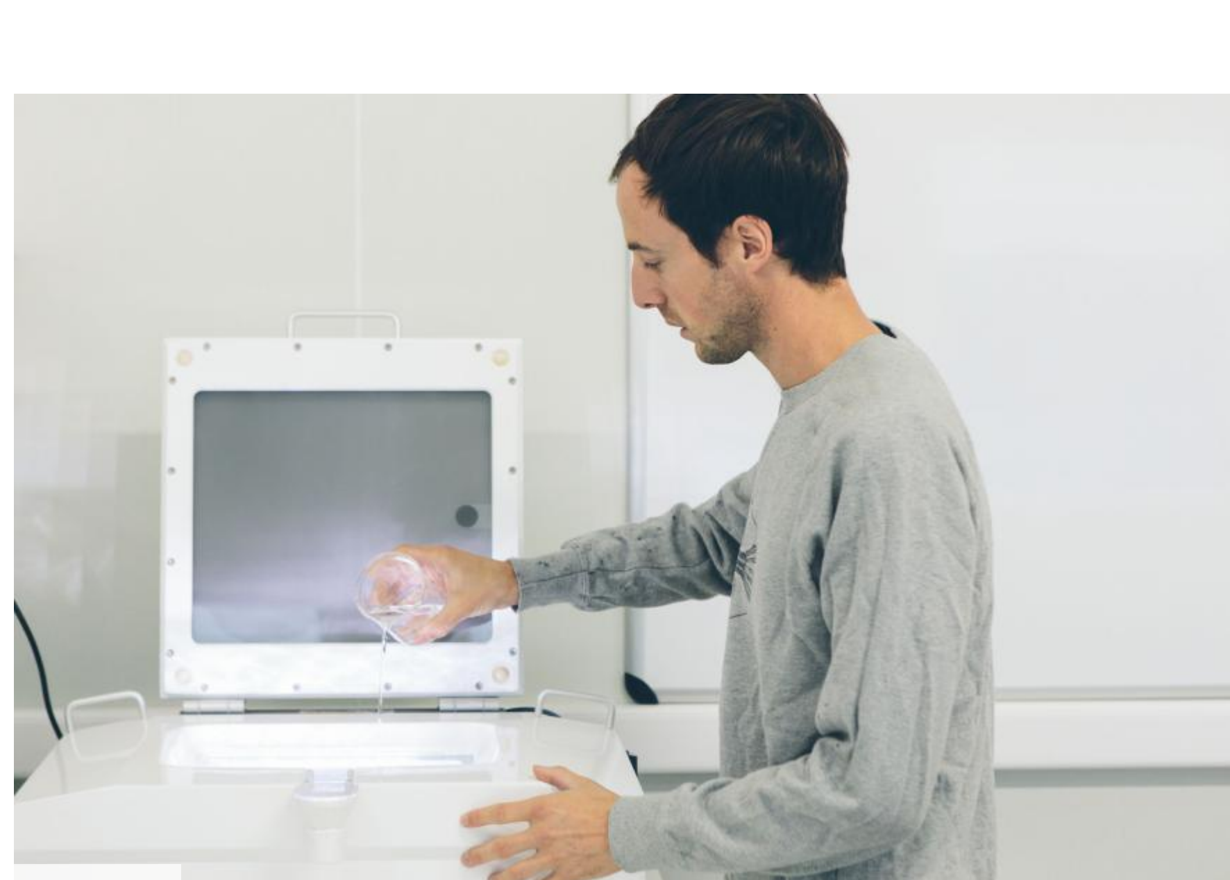
VLIZ | DeSmet LifeWatch/VLIZ-onderzoeker Jonas giet een planktonstaal op de zoöscan, een toestel dat werkt als een scanner voor plankton.
