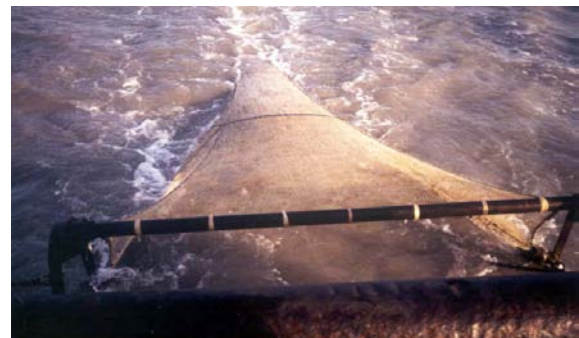
Figure 25. Chalut à perche utilisé en baies de Somme et de Seine lors des campagnes françaises sur les nurriceries côtières. / Beam trawl used in the Bays of Somme and Seine during the French YFS. © IFREMER
