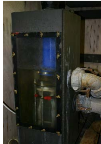
Figure 18. Concentrateur du CUFES à bord du NO Thalassa . / CUFES concentrator on-board RV Thalassa © C. Martin/IFREMER
