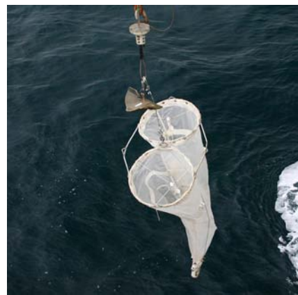
Figure 23. Filet Bongo, utilisé pour l'échantillonnage de l'ichthyoplankton / Bongo net used to sample ichthyoplankton. © C. Martin
