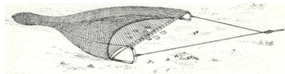
Figure 28. Le chalut à perche utilisé lors de la campagne BTS / The beam trawl used during the BTS. © J. Ellis / Cefas
