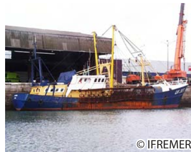
Chalutier à perche (équipé pour la coquille). / Beam trawler (geared for fishing scallops).
