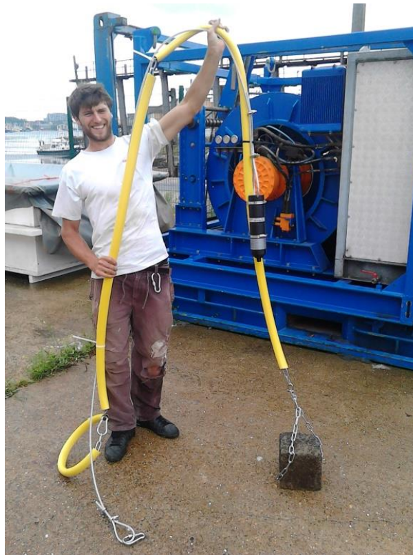
Figuur 4 De detectiestations op de Westerschelde worden met de antenne naar beneden opgehangen aan navigatieboeien. Een gewicht houdt de kabels en het detectiestation op hun plaats.
