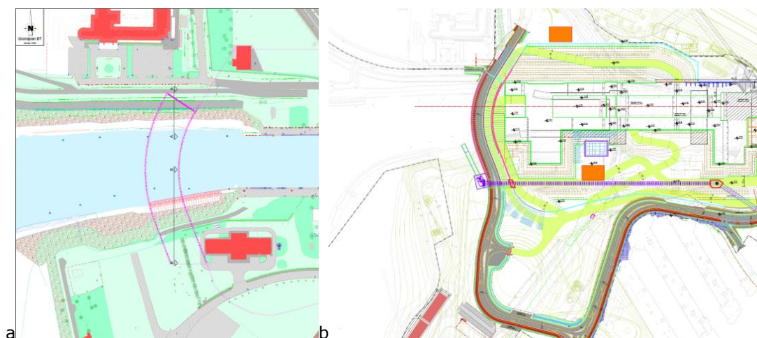
Figuur 1 a: Het projectMER-gebied ter hoogte van de Royerssluis met aanduiding van de tijdelijke kofferdam, b: de werfinrichting en tijdelijke wegenis (bron: Mobiliteit en Openbare werken afdeling Maritieme Toegang).
