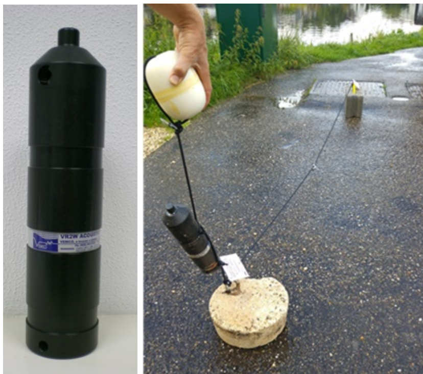
Figuur 3.1. VR2W receiver en bevestigingsmethode aan twee gewichten.
