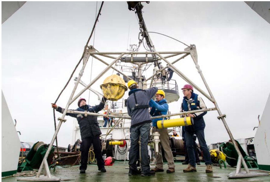
Figuur 2.2: Tripode meetsysteem klaar voor verankering te MOW1 op 28/11/2013. (foto genomen door Jorn Urbain, Belgische Marine).
