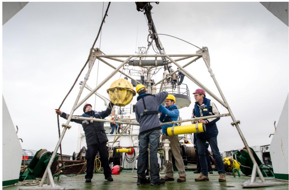
Figuur 2.1: Tripode meetsysteem klaar voor verankering te MOW1 op 28/11/2013. (foto genomen door Jorn Urbain, Belgische Marine).
