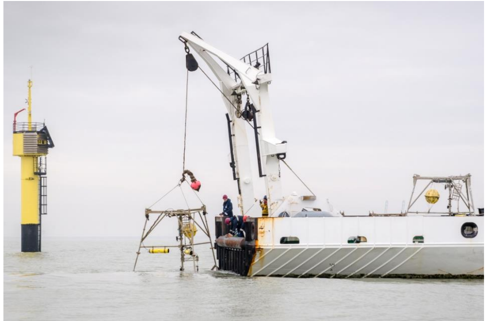
Figuur 4.2: De RV Belgica haalt de tripode aan boord via het A-frame aan meetpaal MOW1 op 28/11/2013. Een andere tripode staat klaar voor verankering. (photo genomen door J. Urbain - Belgische Marine)
