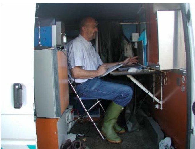
Via telemetrie worden de meetgegevens in een laptop ontvangen
