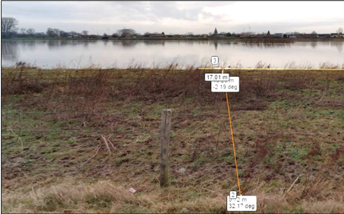
Figuur 3.6 Weergave van de horizontale dijkhoogwatermarge, de breedte van de droge ruimte.
