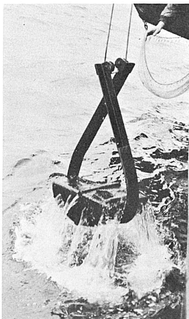
Kastengreifer en van Veen happer in actie voor het onderzoek van de bodemfauna van de Noordzee.
