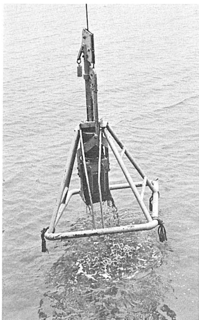
Kastengreifer en van Veen happer in actie voor het onderzoek van de bodemfauna van de Noordzee.
