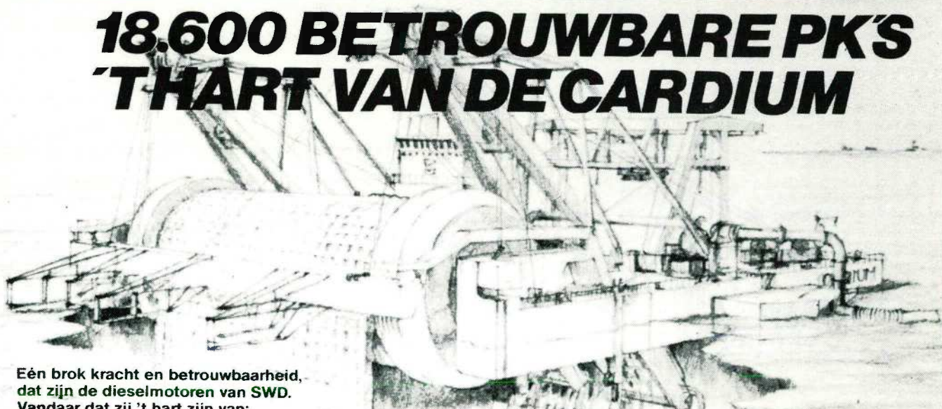
de 9F 240 dieselmotor, 2000 pk bij 1000 omw./min.
