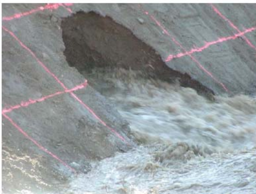
Figuur 40 - Terugschrijdende erosie vanaf de stroomafwaartse kant van de pipe (FLOODSITE)
