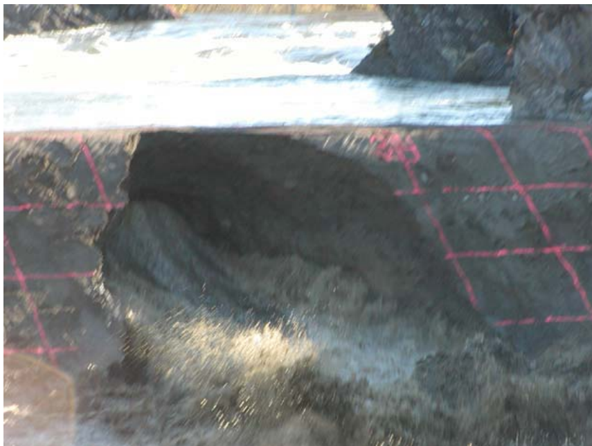
Figuur 41 - Erosie van de pipe tot bijna de kruinhoogte is bereikt (FLOODSITE)
