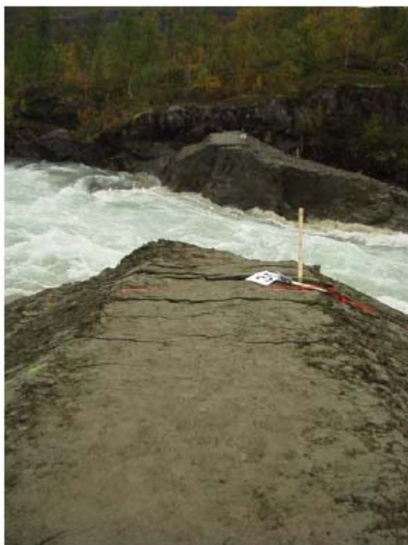
Figuur 24 - Scheuren gevormd in IMPACT Test1-02 bij een homogene cohesieve (klei-)dijk (FLOODSITE)
