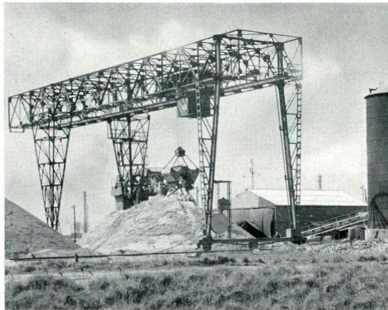
FIG. 34. — L'INSTALLATION GÉNÉRALE DE DÉCARRIAUX. A gauche, le pont-portique de capacité de 1 400 et 1 500 t; à droite, la transporteuse.
