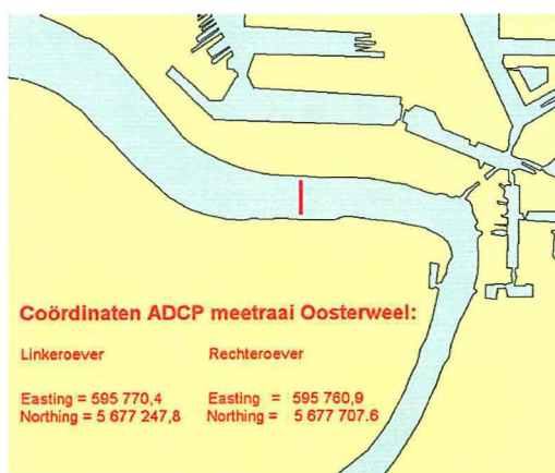
Figuur 2-1: Schematisch overzicht ADCP meetraai Oosterweel
