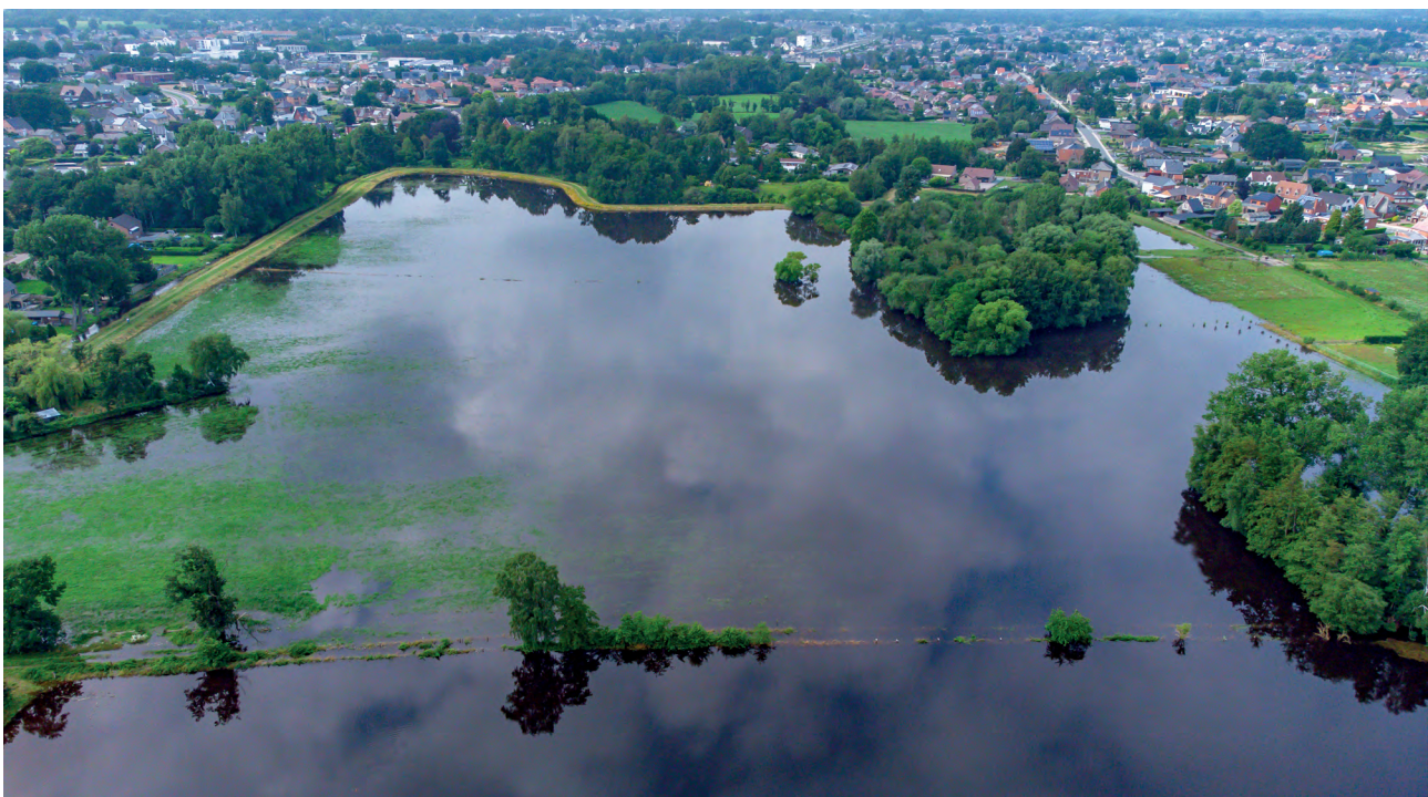
Het wachtbekken in Pelt buffert meer dan 200 miljoen liter water na hevige regenval in juli 2021 (Foto: Marc Faes).
