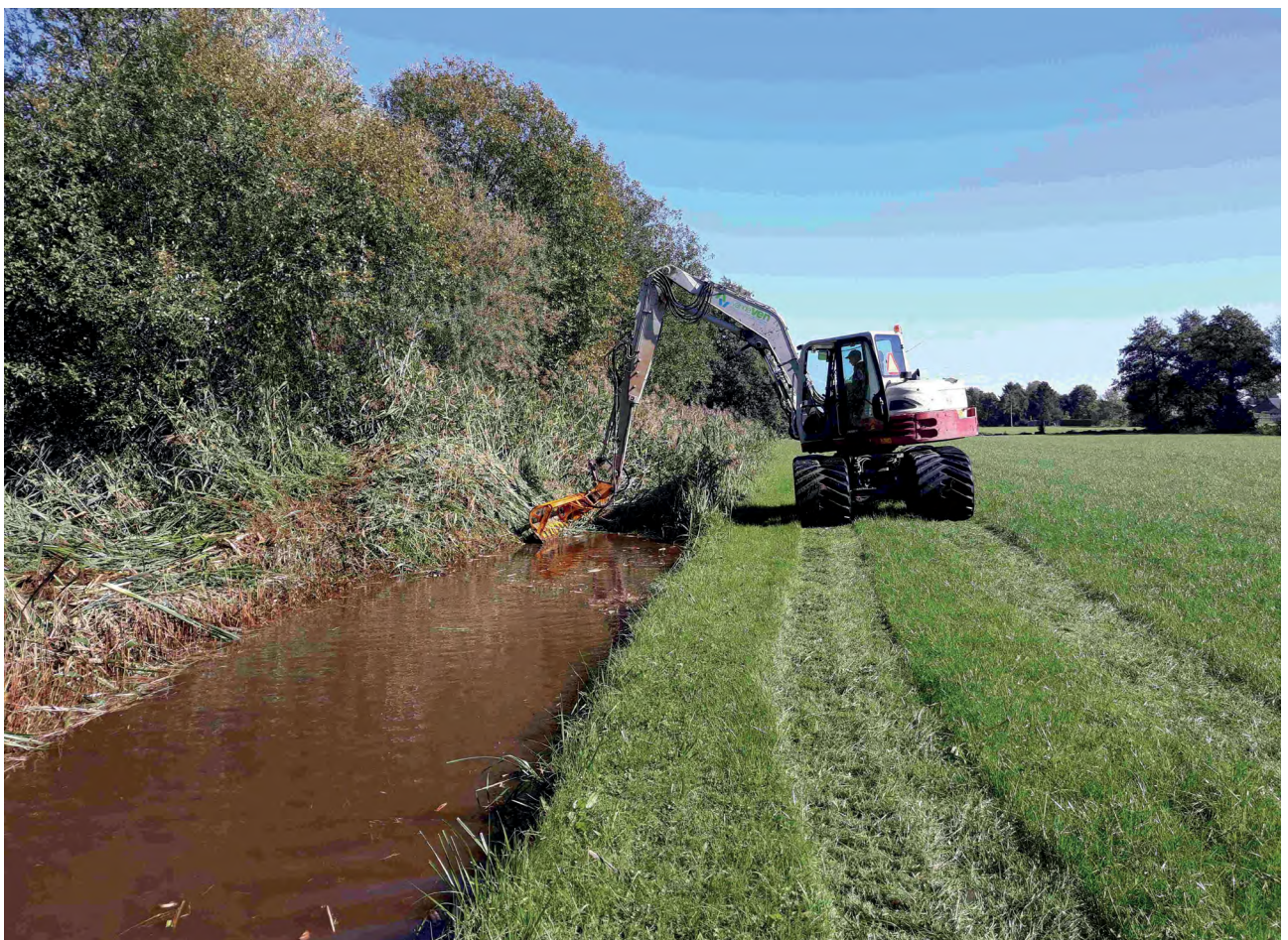
Een aangepast maaibeheer in grachten en waterlopen kan bijdragen tot het langer vasthouden en infiltreren van water (Foto: provincie Limburg).
