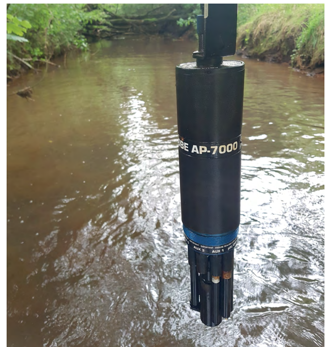
De waterkwaliteit van de Dommel wordt o.a. met een multiparametersonde opgevolgd.
