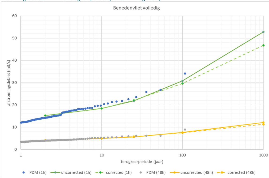
figuur19: Effect van algemene extra reductie (correctie 1, streepjeslijn) van de landelijke afstroming op de aangroei van de afstromingsdebieten i.f.v. de terugkeerperiode (Waasland globaal).
