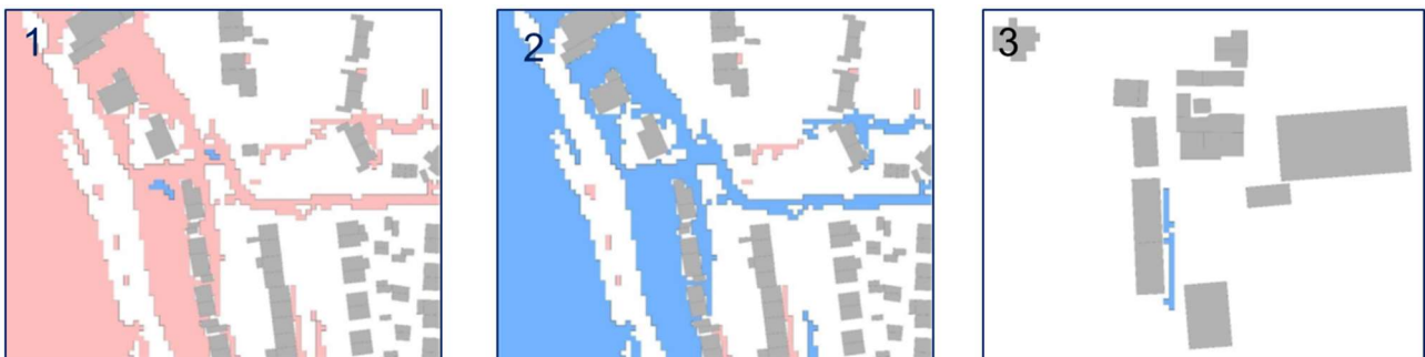
figuur40: Visuele weergave naverwerking van overstromingspolygonen: (1) zones in blauw worden opgevuld, (2) zones in roze worden verwijderd, (3) gecombineerde zones met opp.> 96m 2 worden weerhouden
