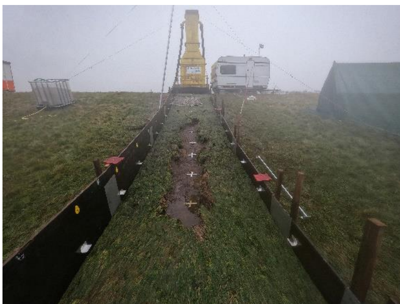
Figuur B-2 Schade na 1,5 uur 190 l/s per 'm bij H_s = 1 m
