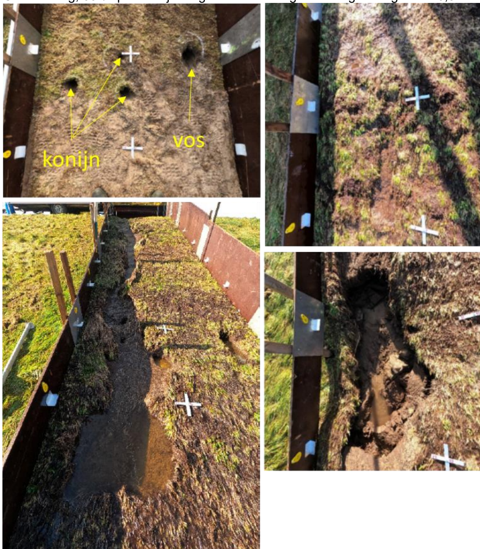
Figuur B-4 Aangebrachte schade vak 11 (linksboven), eerste schade vak 5 na 2,5 uur GO100_1,0 (rechtsboven), 0,25 uur GO190_1,0 (linksonder) en falen na 1 uur GO190_1,0 in vak 10 (rechtsonder)
