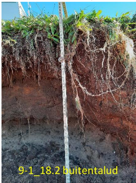
Figuur A-4 Bodemproefiel 9-1 18.2 buiten stroken 2-1 buitentalud en 2-2 binnentalud (boringen gestoken voorafgaand aan de erosieproef)
