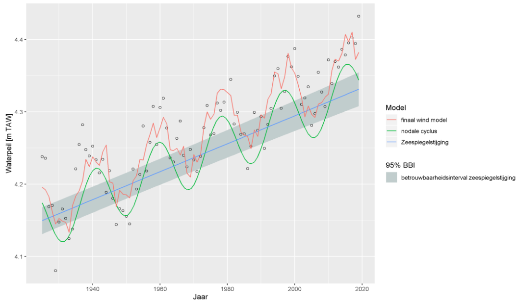
Figuur 14: Model voor gemiddeld HW per jaar in Oostende. Visualisatie van de invloeden van verschillende modelcomponenten. Geen winddata voorhanden tussen 1948-1950. Finaal wind model = trend zeespiegelstijging + nodale cyclus + wind + residu. Nodale cyclus = trend zeespiegelstijging + sinusöide nodale cyclus
