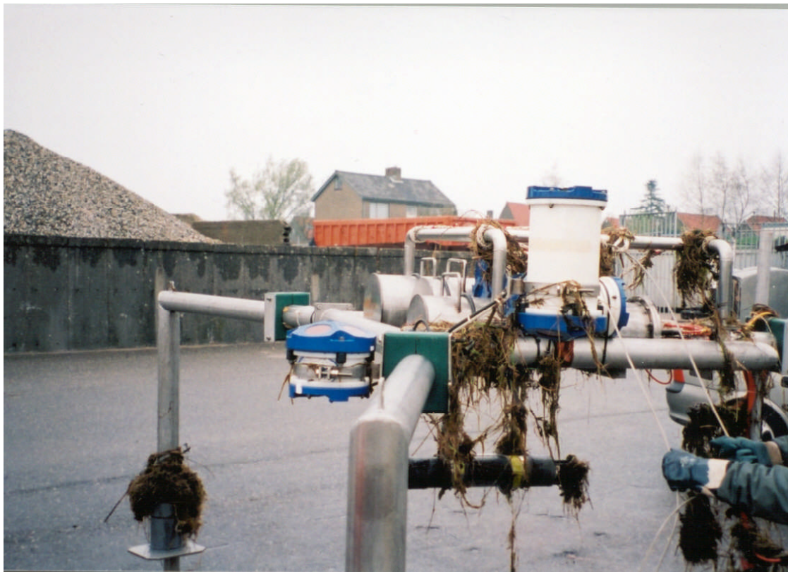
Foto 3. De montage van 2 ADCP's aan de Autonome Meetfaciliteit.
