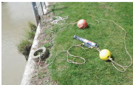
(a) Mouillage préparé pour la station LHOUM
