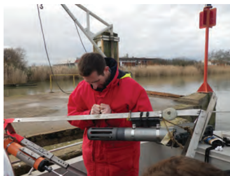
(b) Sonde sur une structure en tripode (station ROCH)
