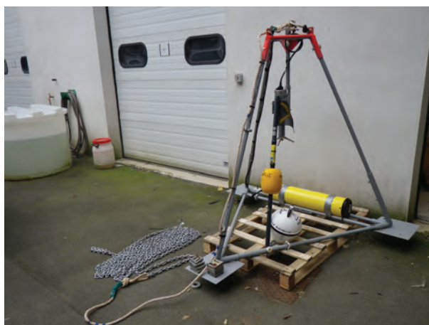
FIGURE 3.5 – ADV haute fréquence placé à Vergeroux
