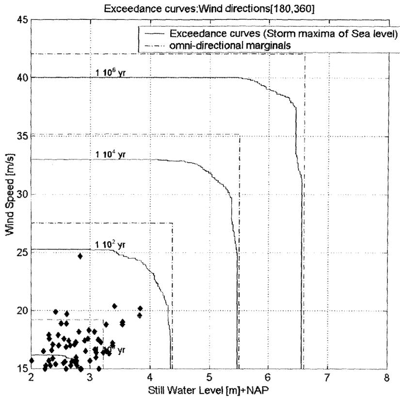
Figuur 9 Offshore (waterstand  $\times$  windsnelheid) overschrijdingscontouren voor windrichtingen tussen  $180^\circ$  en  $360^\circ$  graden en data gebaseerd op waterstandsmaxima voor locatie Westerschelde\_2, profiel 'Zeeland' (coördinaten (14990,376342)).
