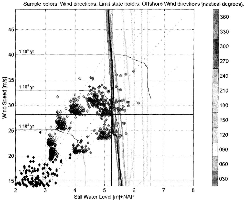
Figuur 6a Offshore (waterstand × windsnelheid) ontwerp punt, 'limitstates', overschrijdingscontouren en samples m.b.t. kruinhoogte en data gebaseerd op waterstandsmaxima voor Westerschelde\_2 (coördinaten (14990, 376342)).
