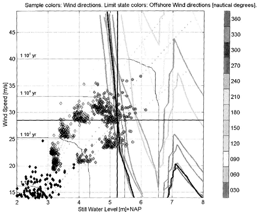
Figuur 7a Offshore (waterstand  $\times$  windsnelheid) ontwerp punt, 'limitstates', overschrijdingscontouren en samples m.b.t. steendikte van laag 1 en data gebaseerd op waterstandsmaxima voor Westerschelde\_2 (coördinaten (14990, 376342)).
