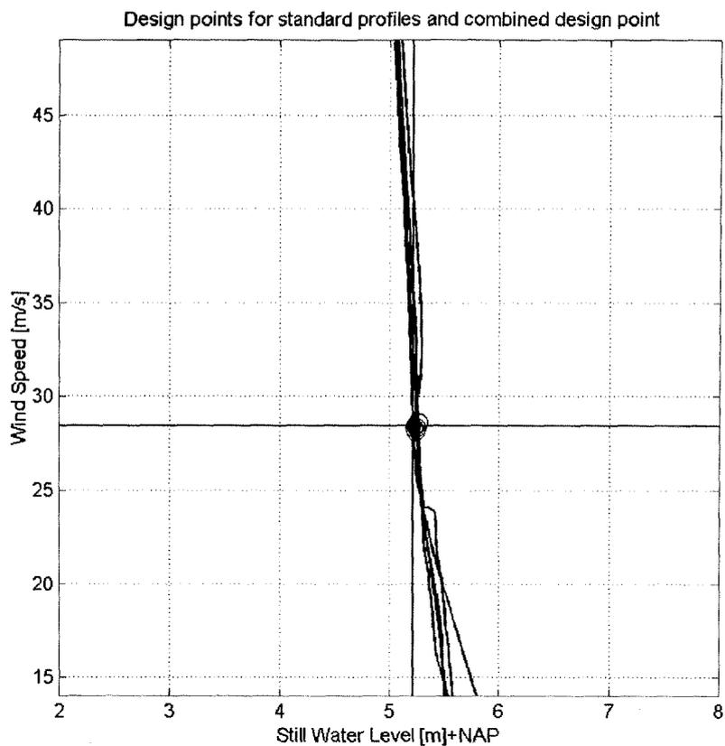
Figuur 8 Offshore (waterstand  $\times$  windsnelheid) ontwerppunten, gecombineerde ontwerppunt en projecties van 'limit states' voor standaardprofielen m.b.t. kruinhoogte en data gebaseerd op waterstandsmaxima voor locatie Westerschelde\_2 (coördinaten (14990,376342)).
