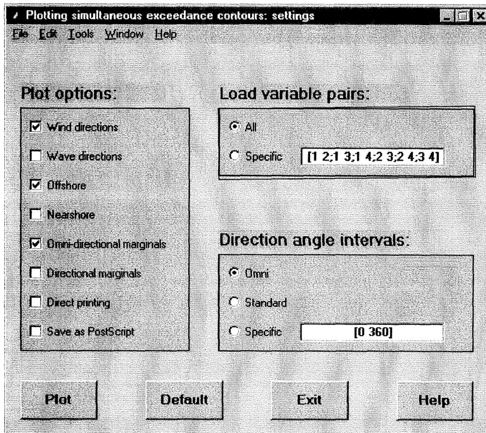
Figuur 2 Interface voor plotten van richtingsafhankelijke overschrijdingscontouren.
