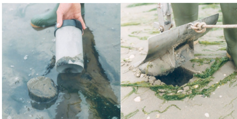
Figuur 2.1 steekbuis en kokkelschuif die worden gebruikt voor de RIVO-survey (Bult et al, 2004).
