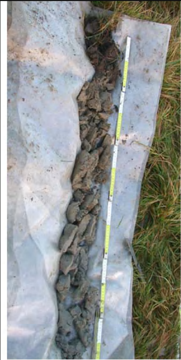
ZWB39 : relatief ongestoord profiel bestaande uit klei met sintels in de A en lokaal een zandig laagje rond 20cm diepte
